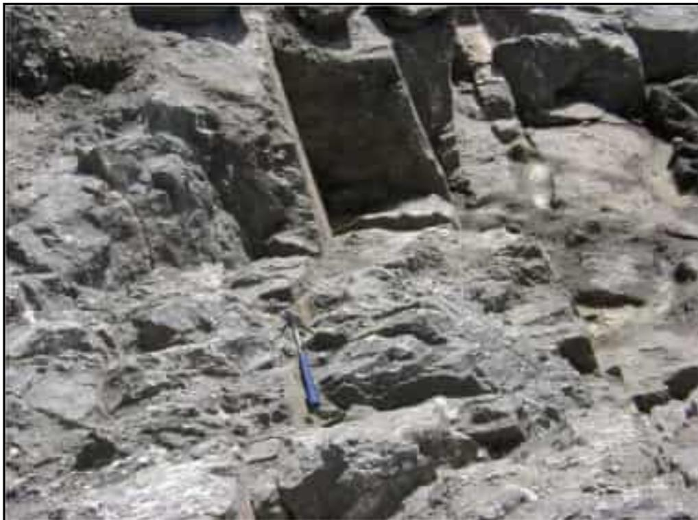
**Foto 08** – Planos preferenciais de fraturamento, segundo as direções N120/80SW e N70/SV, estaca 29D+10.
