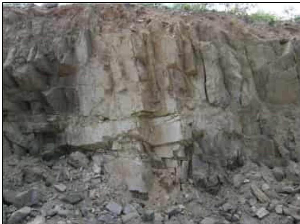
**Foto 04** – Planos preferenciais de fraturamento, associados a planos sub-horizontais de alívio, ocasionando blocos de tamanhos diversos.
