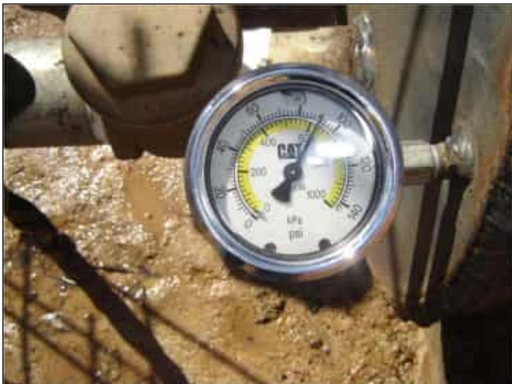
**Foto 08** – Início do teste hidrostático dos tubos registrando pressão manométrica de 90Psi no dia 18/11/10 as 08 horas e 40 Minutos.
