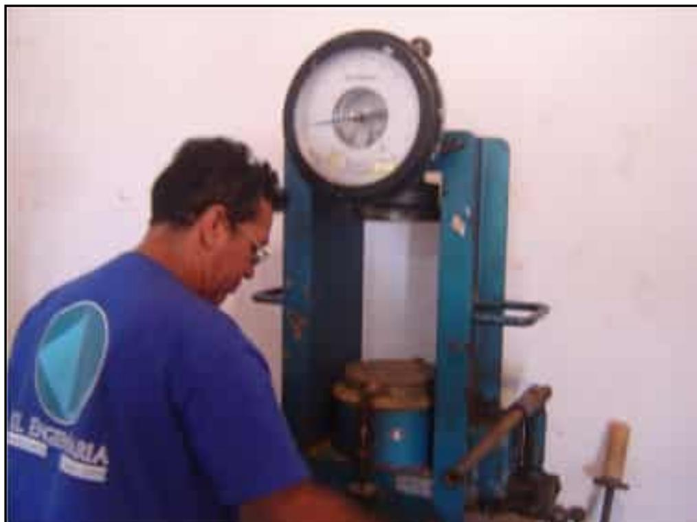
**Foto 13** – Equipe supervisora acompanhando o rompimento de corpo de prova.
