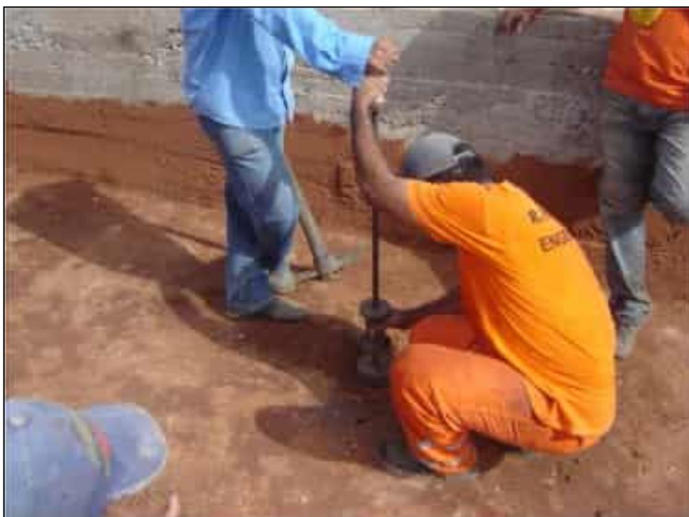
**Foto 04** – Realização do ensaio de compactação da camada de argila próximo ao concreto de regularização da tomada d'água.
